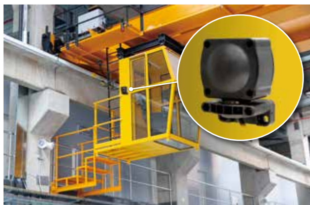
構内クレーンの衝突防止
